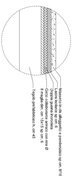
Dettaglio del solaio di copertura
